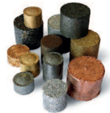
Brikety se dají lisovat z nejrůznějších odpadů vzniklých obráběním kovů.
