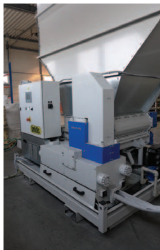
Briketovací lis iSwarf 440-4-55
