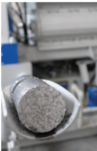
Briketa z hliníkových třísek
