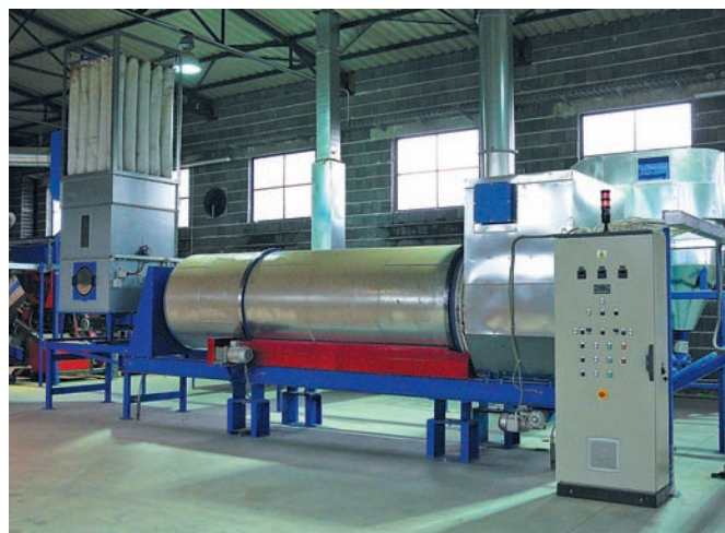
Sušárna BUS vysuší materiál až na 12% vlhkosti
